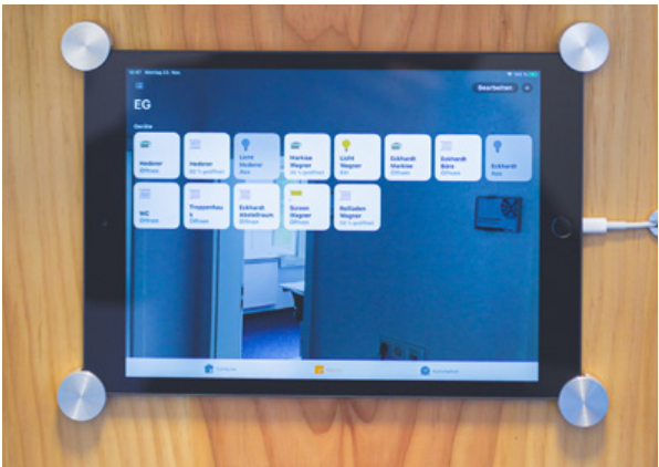
Becker 大楼通过 OPUS 网关进行控制并集成到 Apple HomeKit（Apple HomeKit 是 Apple Inc. 的商标）中。并且可以通过平板电脑这个中心点控制一切。
